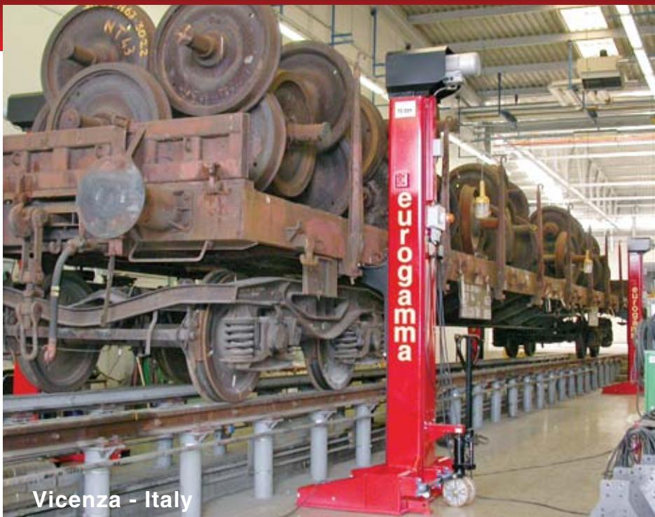
Hebe- und Wartungsanlagen für alle Arten von Schienenfahrzeugen.
